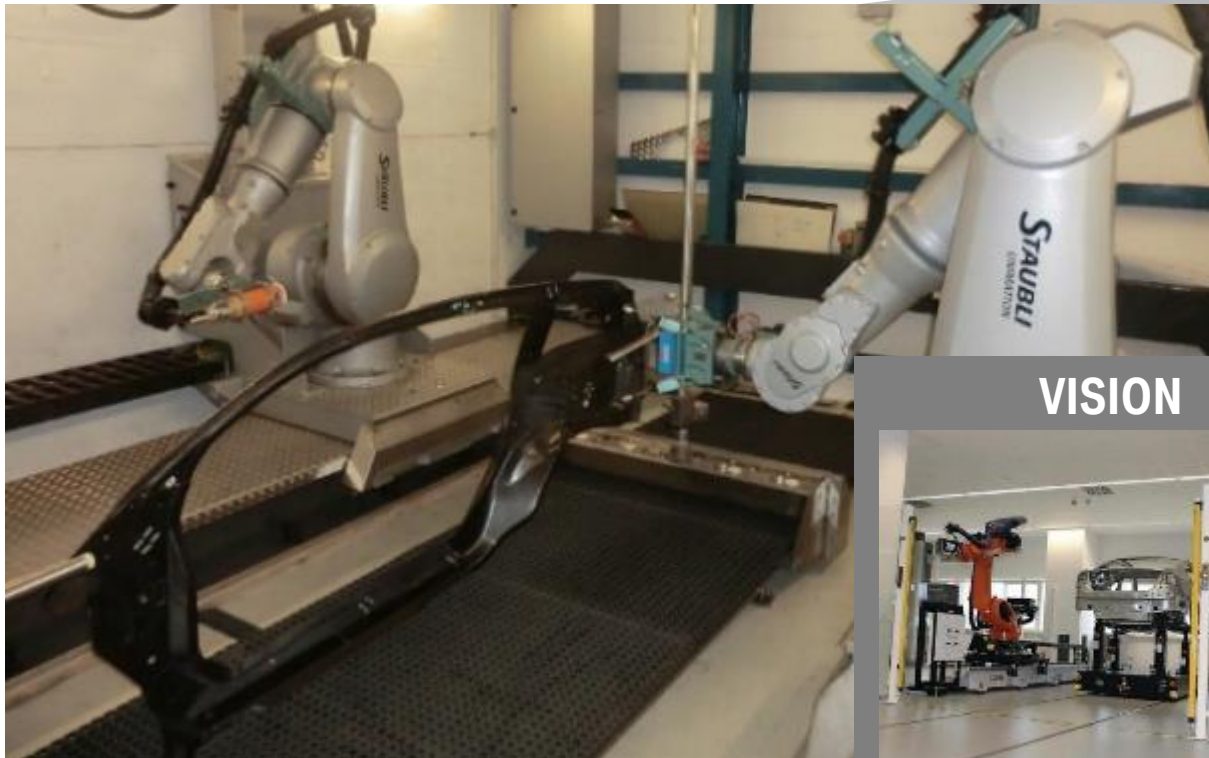
Roboter-CT am Seitenrahmen BMW i3
