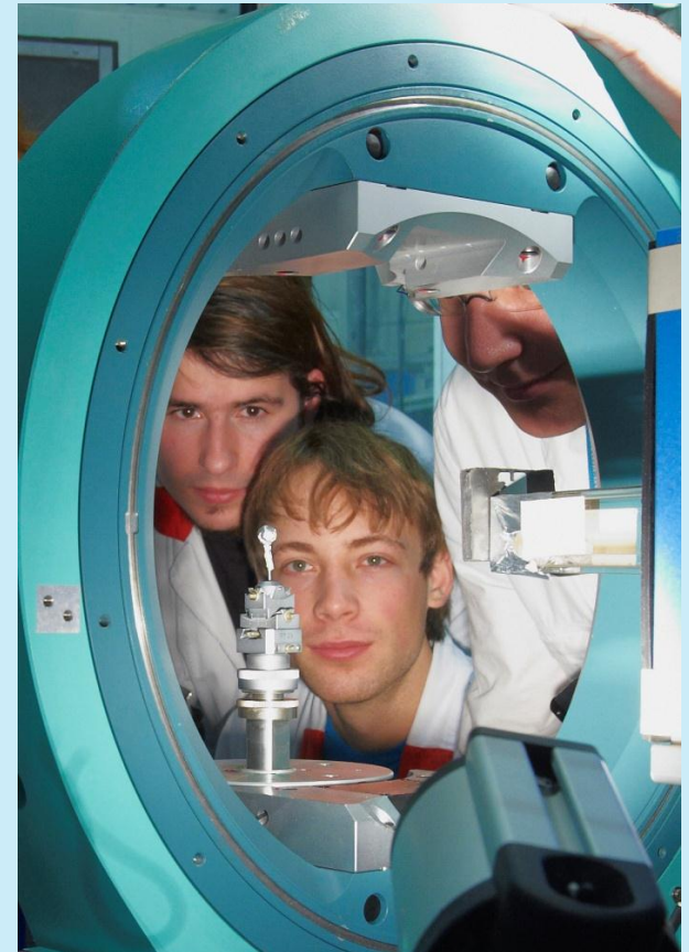
Studenten und Wissenschaftler am Einkristalldiffraktometer RESI der Forschungs-Neutronenquelle beim Vorbereiten einer Messung mit Neutronen. Copyright: Wenzel Schürmann / TU München
